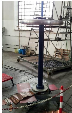
Figura 2 - Divisore capacitivo smorzato HAEFELY R600
