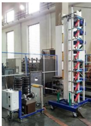
Figura 3 - Generatore di impulsi HAEFELY SGSA 800/40
