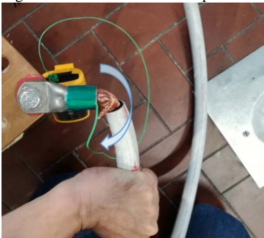
Fig.13. Rotazione di un cavo di prova intorno al piano del capocorda.
