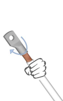
Fig.12. Torsione di un cavo di prova intorno al proprio asse di simmetria.
