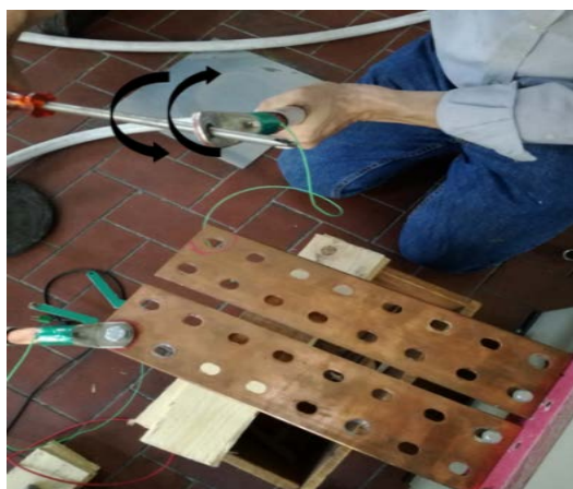
Fig.15a. Torsione di 180^\circ del cavo in senso orario ed antiorario.
