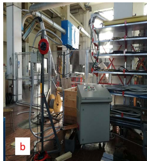
Fig.33. Sistema di misura per prove di sovratemperatura: viste frontale (a); laterale (b).
