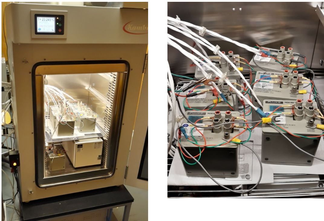
Fig. 4 – A sinistra si osserva uno dei due bagni Kambic utilizzati per il condizionamento termico. I resistori vengono portati alla temperatura di misura e misurati in seguito all'esaurimento dei transistori termici. A destra si osserva un particolare delle connessioni dei resistori nel campo compreso tra 1 e 19 kohm. Per tali resistori sono state utilizzate delle connessioni a basso rumore termico, costituite da cavi argentati e isolati in teflon con capicorda a forcilla in rame elettrolitico puro crimpate.
