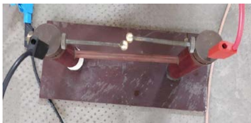
Fig. 24a. Spinterometro a sfere dopo la manutenzione
