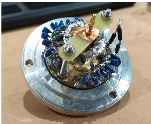
Fig. 20b. Ramo di bassa tensione del divisore. In blu i condensatori in polipropilene, in nero i resistori in serie per R_{BT} , in azzurro con righe trasversali i resistori in serie alle capacità. Due dischi forati di metallo creano il cortocircuito per mettere i dispositivi in parallelo.
