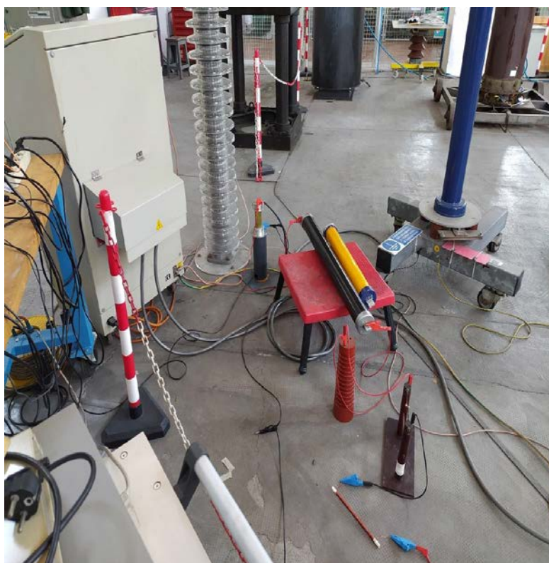
Fig. 33. Circuito per la misura della tensione composta sul generatore di tensione sinusoidale.
