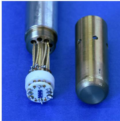
Figura 2: La parte inferiore dell'inserto che si inserisce nel criomagnete. Lo schermo di ottone è stato rimosso per mostrare il portacampioni TO-8, che ospita un dispositivo in GaAs, e le connessioni coassiali.
