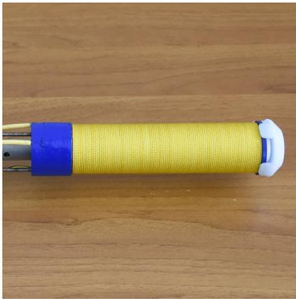
Figura 1: Il criomagnete, montato all'estremità del discendente, raggiunge un campo magnetico di 6 T a 4.2 K. Il magnete include un interruttore superconduttivo per operare in modo persistente.
