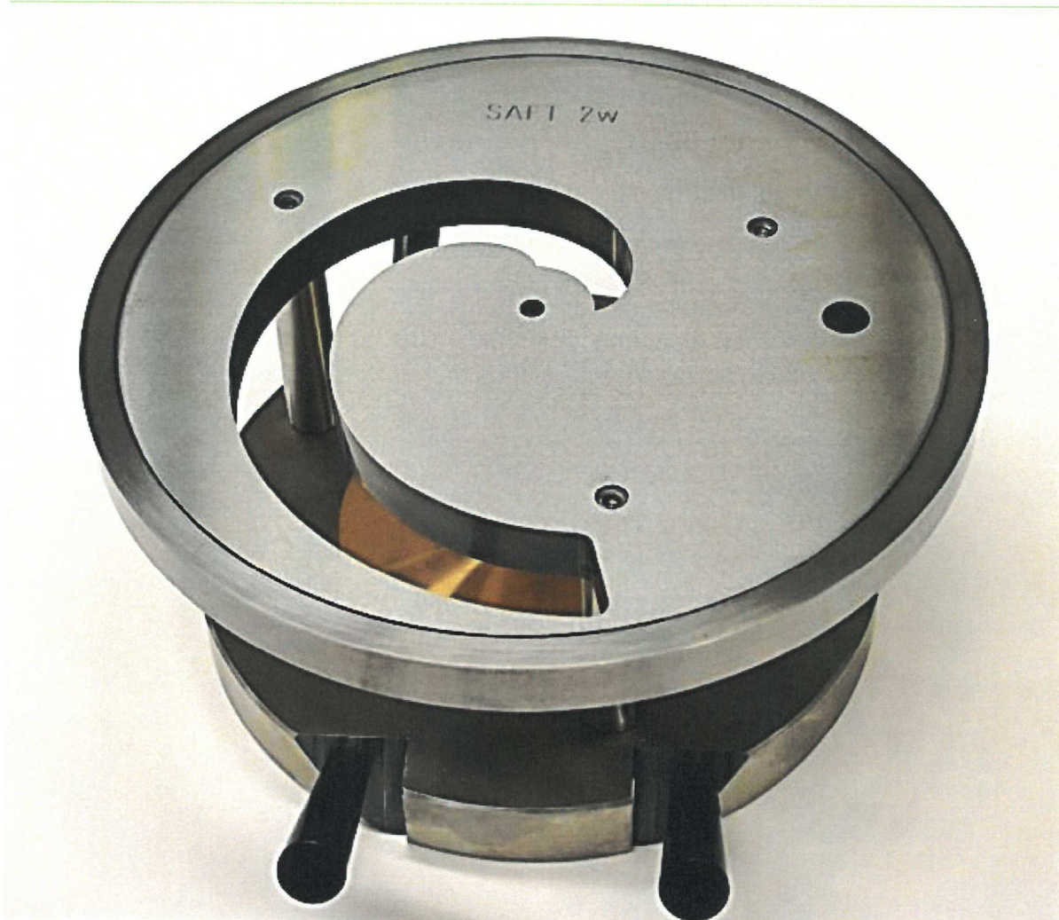
Wellenbehaftetes Evolventen-Scanning-Normal samt Auflagevorrichtung Involute waviness scanning measurement standard with subbase
