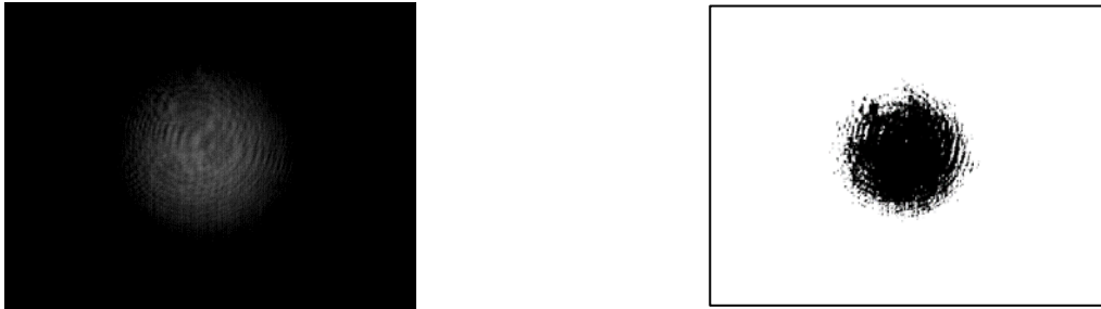
Figura 30: a sinistra: spot acquisito dalla camera Epix in corrispondenza della posizione centrale (N°5), con un framerate di 25 FPS e con un tempo di esposizione di 1.5 ms; a destra: immagine binaria dello stesso spot
